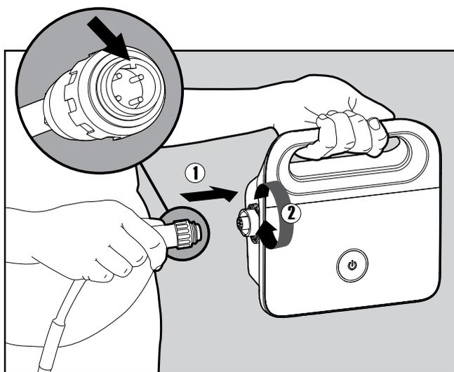
**5.1.3** Connectez le câble flottant à l'alimentation, alignez l'ergot du connecteur avec l'encoche de la prise sur l'alimentation (1), puis tournez dans le sens des aiguilles d'une montre (2).
