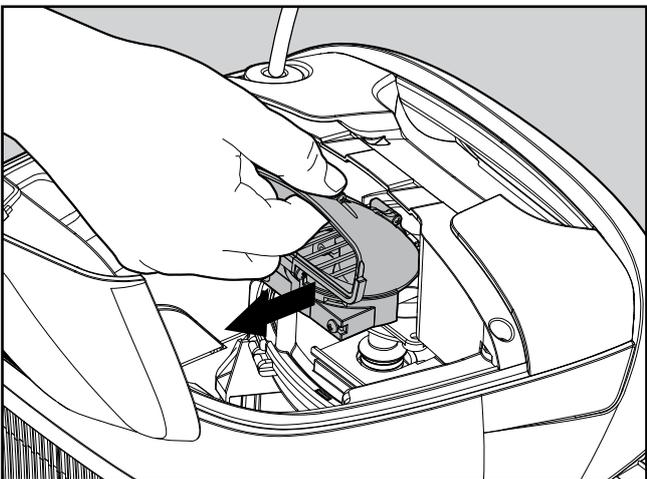
**8.1.3** Tirez le couvercle de l'hélice vers l'arrière pour le dégager. Enlevez les déchets qui encombrant l'hélice. Réassemblez le couvercle de l'hélice.
