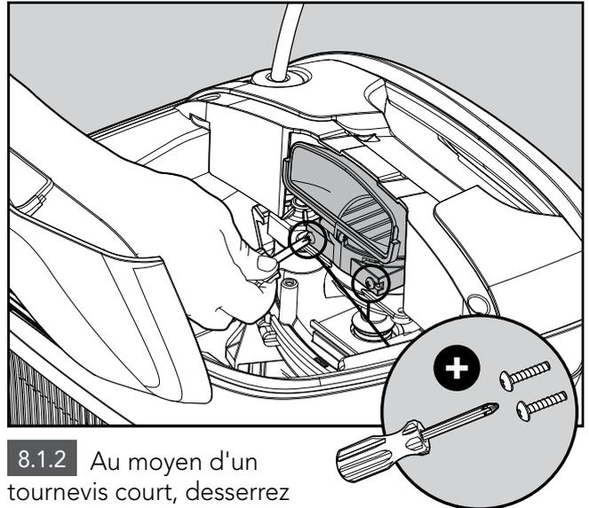
**8.1.2** Au moyen d'un tournevis court, desserrez les 2 vis.
