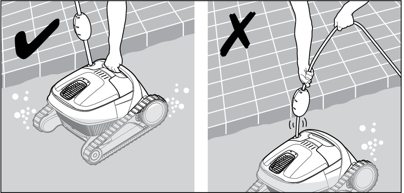
**5.3.2** Au moyen du câble flottant, rapprochez le nettoyeur du bord de la piscine.
