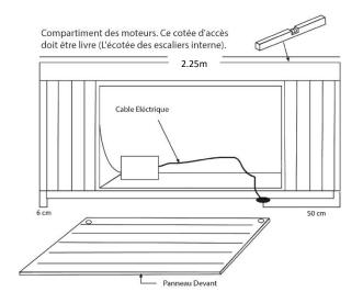
IMPORTANT: Le matériel doit être connecté à une ligne de tension exclusive et permanente, capable de supporter la puissance installée. Tous les appareilles électriques et de lumière électrique doivent être localisé plus que 1,5 mètres de la Spa. Le circuit de terre doit être capable d'assurer la sécurité du matériel. L'installation électrique doit être selon la législation actuelle.
